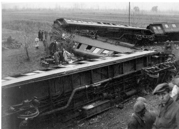
22. Kisiklás sántörés miatt Ceglédbercel-Cserő és Albertirsá között. 1948
